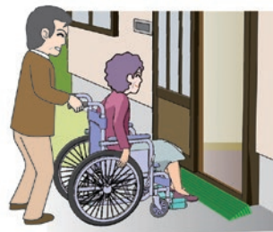
屋外での段差解消
